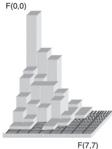
**Abbildung 3.11:** DCT-Koeffizienten. Links: typische Werteverteilung bei Bildern. Der DC-Anteil  $F(0,0)$  ist hoch. Hohe Frequenzanteile (vorn und rechts) sind niedrig und oft null. Rechts: Zick-Zack-Scan zum Auslesen der AC-Koeffizienten.
