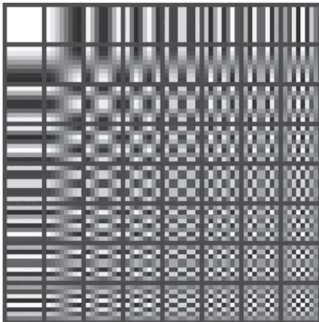
**Abbildung 3.10:** 64 Basismuster für die DCT, jedes Basismuster besteht aus  $8 \times 8$  Werten, die unterschiedliche Frequenzanteile des Bildes repräsentieren. Ganz oben links ist die DC-Komponente. Die Muster weiter rechts entsprechen höheren horizontalen, die weiter unten höher werdenden vertikalen Frequenzen.
