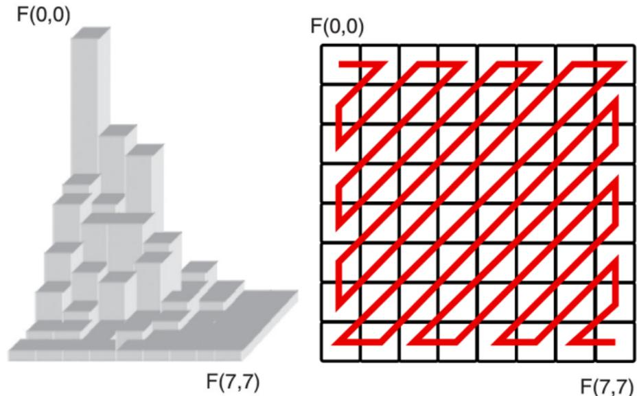
**Abbildung 3.11:** DCT-Koeffizienten. Links: typische Werteverteilung bei Bildern. Der DC-Anteil  $F(0,0)$  ist hoch. Hohe Frequenzanteile (vorn und rechts) sind niedrig und oft null. Rechts: Zick-Zack-Scan zum Auslesen der AC-Koeffizienten.
