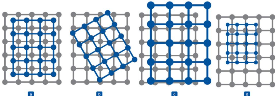
**Abbildung 3.14:** Probleme bei geometrischen Operationen. Blaues Raster: transformiertes Pixelraster des Originalbildes; graues Raster: Pixelraster des Zielbildes bei (a) Verschiebung, (b) Drehung, (c) Vergrößerung, (d) Verkleinerung
