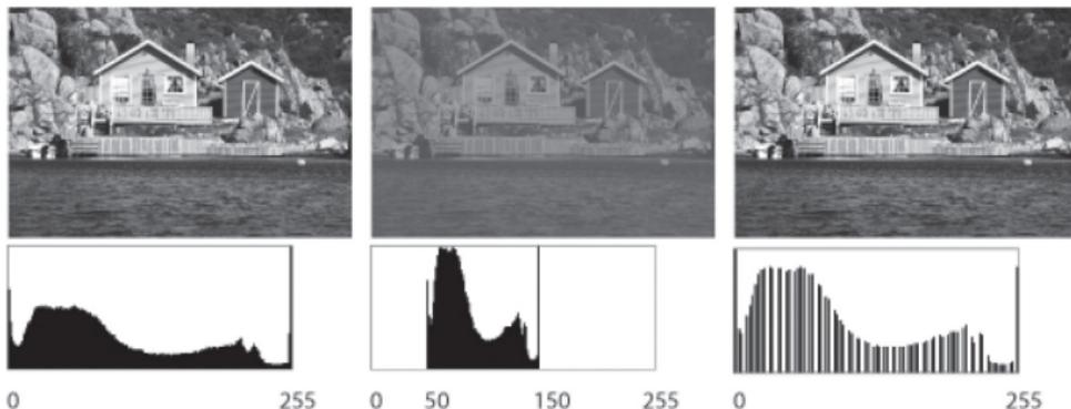
**Abbildung 3.12:** Grauwertbilder mit Histogrammen. Linkes Bild: Alle Grauwerte kommen vor. Mittleres Bild: Nur Grauwerte zwischen 50 und 150 kommen vor. Rechtes Bild: Spreizung der Grauwerte auf den ganzen Bereich, wobei das Ausgangsbild das mittlere Bild ist.
