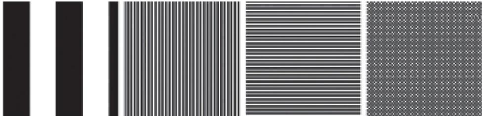
**Abbildung 3.9:** Bilder mit unterschiedlichen horizontalen und vertikalen Frequenzanteilen, von links nach rechts: (1) niedrige horizontale Frequenzen, (2) nur hohe horizontale Frequenzen, (3) nur hohe vertikale Frequenzen, (4) Mischung hoher horizontaler und vertikaler Frequenzen
