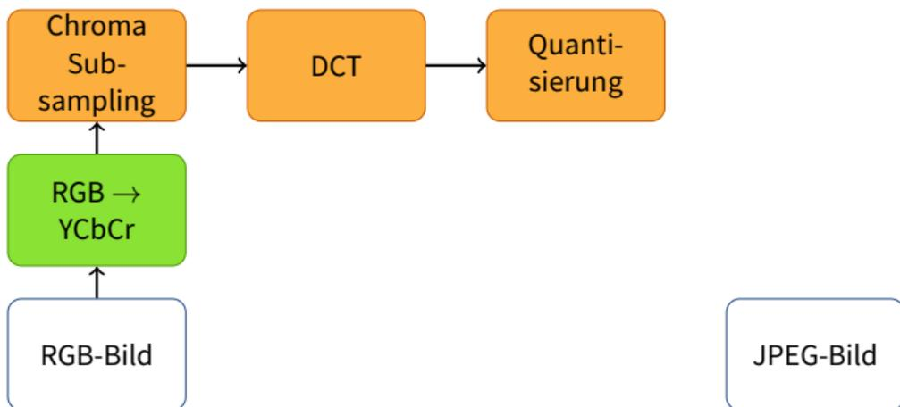
Quantisierung der Koeffizienten durch geeignete Quantisierungsmatrix, Reduktion Wertebereich, hohe Frequenzanteile Null
