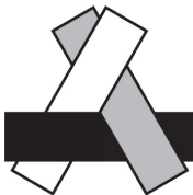
Abbildung 8.13: Drei Polygone, die sich zirkulär gegenseitig überlappen und daher mit dem Painter's Algorithm nicht korrekt dargestellt werden können
