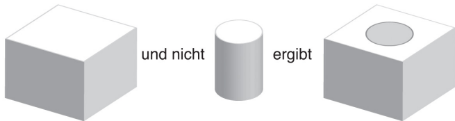
Abbildung 8.2: Boolesche Verknüpfung eines Quaders mit einem Zylinder
