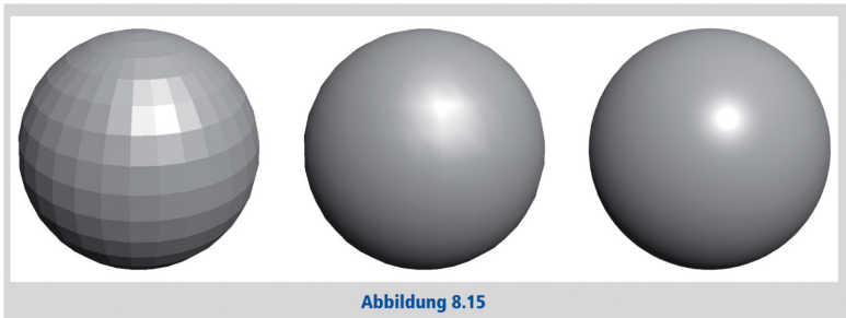
Abbildung 8.14: Funktionsweise des Flat Shading, Gouraud Shading und Phong Shading
