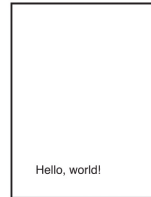
Abbildung 5.12: Einfaches PostScript-Programm, das an den Koordinaten (100, 100) den Text „Hello, world!“ in der Schriftart Helvetica und dem Schriftgrad 48 Punkt ausgibt
