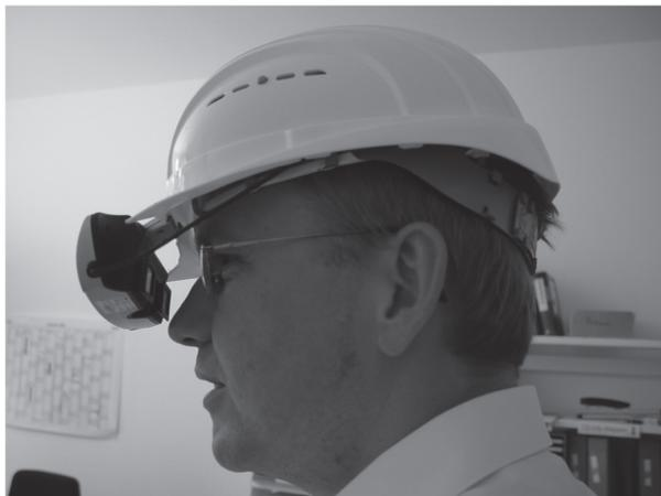
Abbildung 9.7: Beispiel eines Head-Mounted Displays (Foto: TZI)
