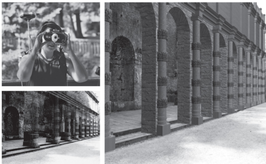
Abbildung 9.9: Beispiel für Augmented Reality. Nutzer erhalten eine Brille, durch die einerseits die Umwelt gesehen werden kann, in die aber auch Überblendungen von computergenerierten Inhalten eingeblendet werden können. In GEIST werden so zu Ruinen von Gebäuden Rekonstruktionen von Gebäudeteilen eingeblendet.
