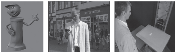
Abbildung 9.3: Interaktionsagent von SmartKom (linkes Bild). Dieser Agent kann selbst Gesten und Mimik darstellen und spricht mit dem Nutzer. Bild Mitte und rechts stellen zwei Systemvarianten von SmartKom dar, einmal für Fußgänger und einmal an einem öffentlichen Informationskiosk.
