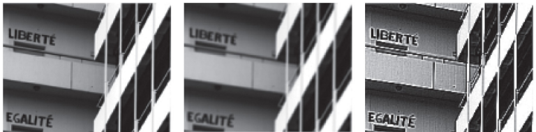
Abbildung 3.13: Linkes Bild: Original, Mitte: einfacher Weichzeichner, rechts: einfacher Scharfzeichner (Boost-Filter)
