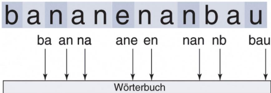
**Abbildung 2.9:** Ablauf des LZW-Algorithmus an einem Beispiel
