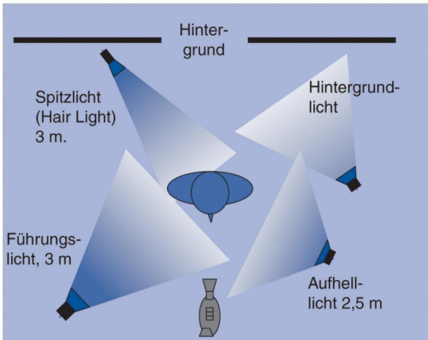
**Abbildung 6.10:** Aufbau einer Vierpunktausleuchtung
