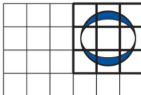
**Abbildung 6.7:** Block-Matching mit zusätzlicher Differenzcodierung, wenn die Blöcke nicht völlig identisch sind. Die unterste Zeile zeigt die Differenzinformation für die verschobenen Blöcke an.
