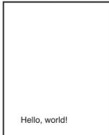
**Abbildung 5.12:** Einfaches PostScript-Programm, das an den Koordinaten (100, 100) den Text „Hello, world!“ in der Schriftart Helvetica und dem Schriftgrad 48 Punkt ausgibt
