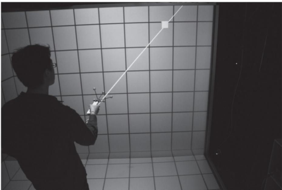
**Abbildung 9.8:** Nutzer einer Cave mit einem visuellen 3D-Tracking für Handgesten
