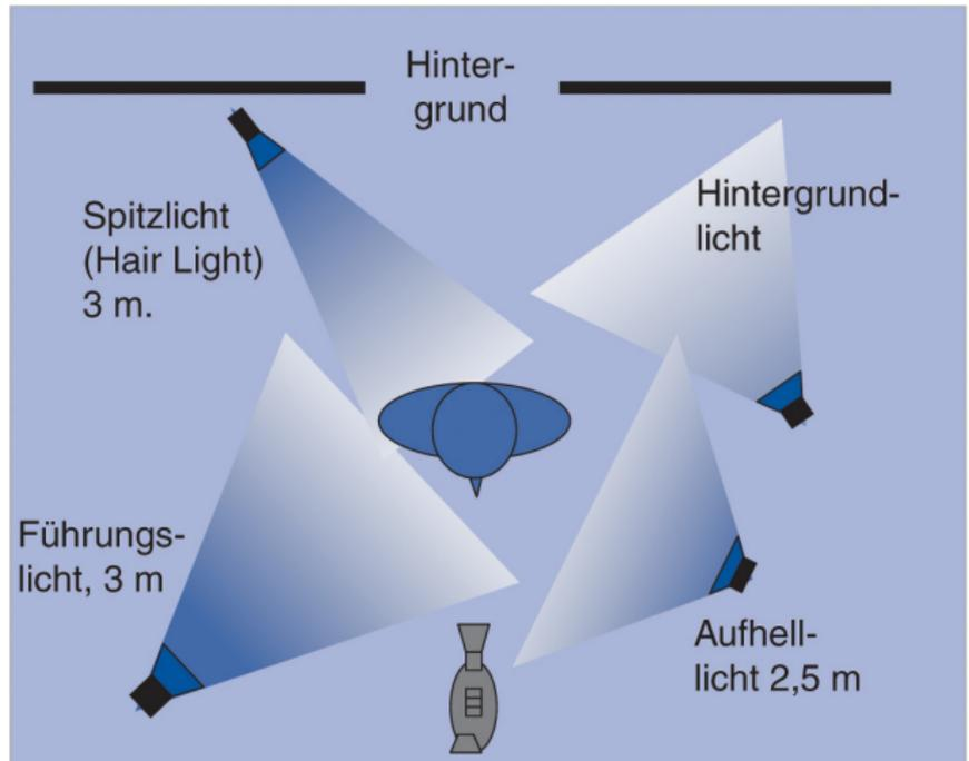
**Abbildung 6.10:** Aufbau einer Vierpunktausleuchtung
