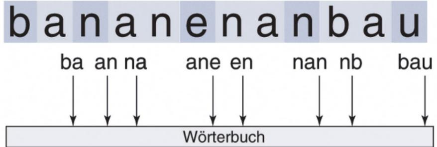
**Abbildung 2.9:** Ablauf des LZW-Algorithmus an einem Beispiel
