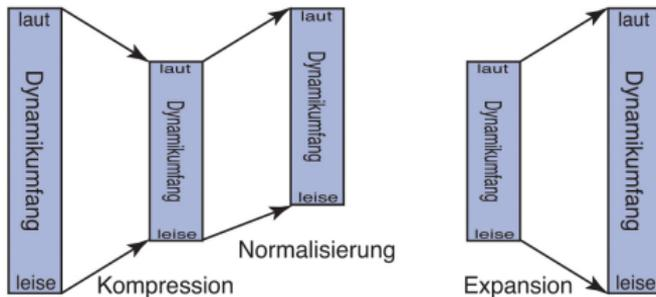
Abbildung 4.19: Kompression und Expansion der Dynamik eines Audiosignals
