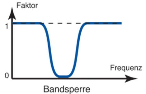
**Abbildung 4.17:** Die vier grundlegenden Arten von Frequenzfiltern
