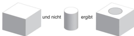
Abbildung 8.2: Boolesche Verknüpfung eines Quaders mit einem Zylinder
