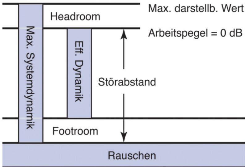
**Abbildung 4.15:** Headroom, Footroom, Dynamik und Störabstand eines Signals
