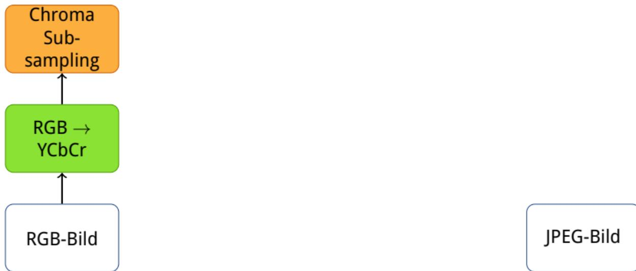
Chroma-Subsampling: Ggf. Reduzierung Auflösung Cb- und Cr-Kanal (Viertelung, Halbierung Horizontal, Halbierung Vertikal)
