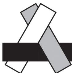
**Abbildung 8.13:** Drei Polygone, die sich zirkular gegenseitig überlappen und daher mit dem Painter's Algorithm nicht korrekt dargestellt werden können
