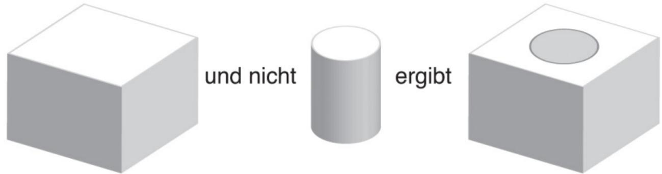
**Abbildung 8.2:** Boolesche Verknüpfung eines Quaders mit einem Zylinder
